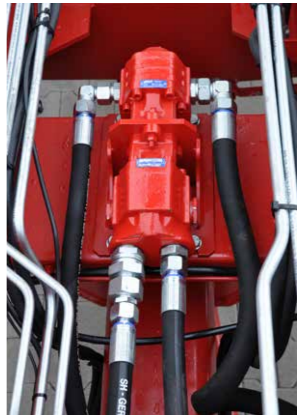
Pompa hydrauliczna napędzana przez silnik olejowy.
