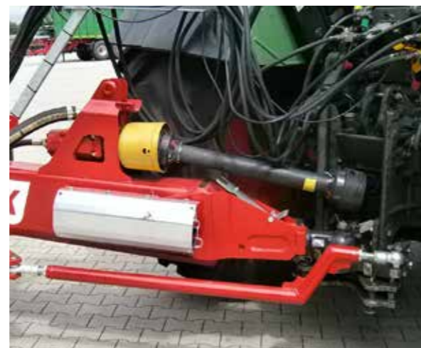
Pompa hydrauliczna napędzana przez wał odbioru mocy.
