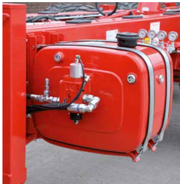
Zbiornik hydrauliczny (własne zasilanie olejem)
